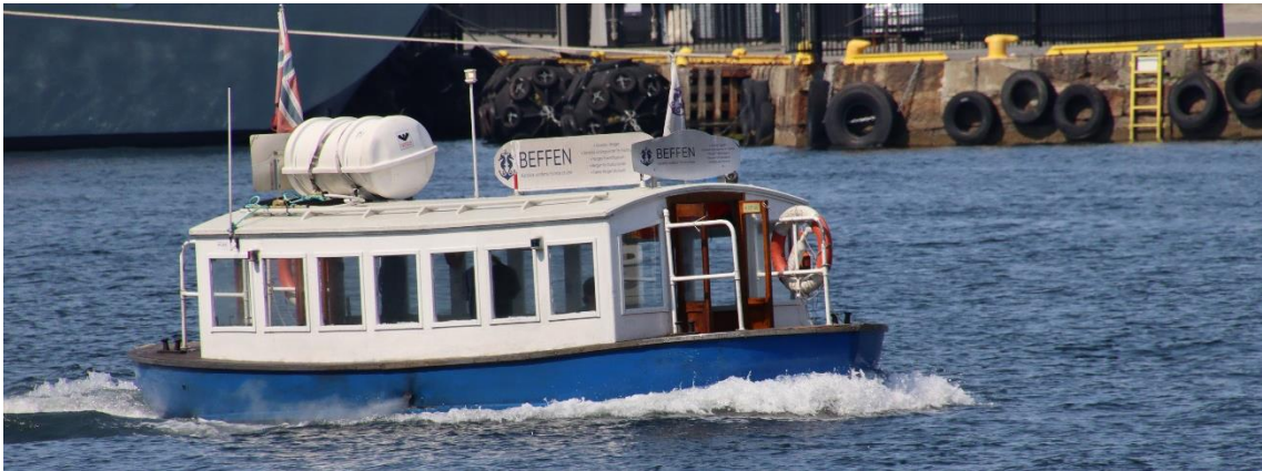
ベルゲン港内の渡船です。屋根にライフラフトのカプセルを積んでいるようです。
