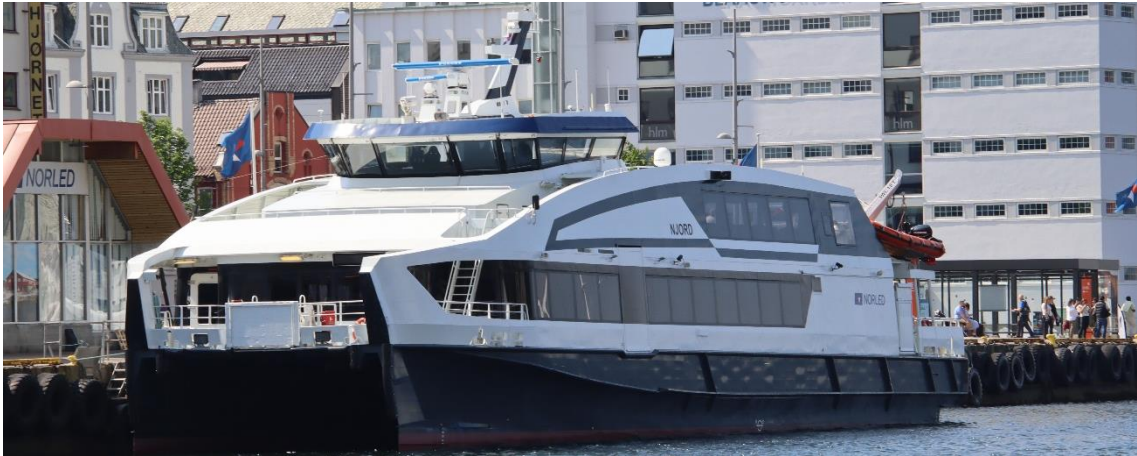
ベルゲンフィヨルド内の定期航路に就航する高速旅客船「NJORD」。最高速度は 27 ノットとのことです。
